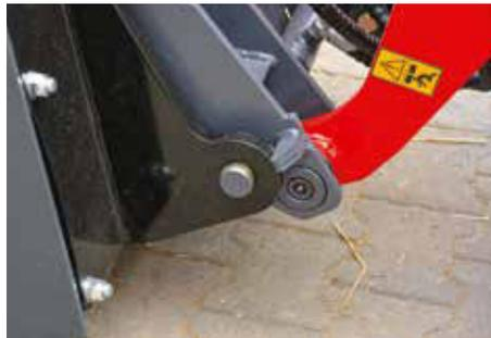
Beim Werkzeugwechsel muss der Fahrer dank Schnellverschlussystem nicht absteigen.
