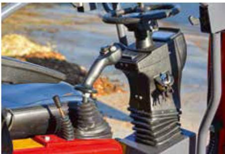
Der Joystick befindet sich rechts neben dem Fahrer. Gleich dahinter der Hebel für den dritten Steuerkreis.
