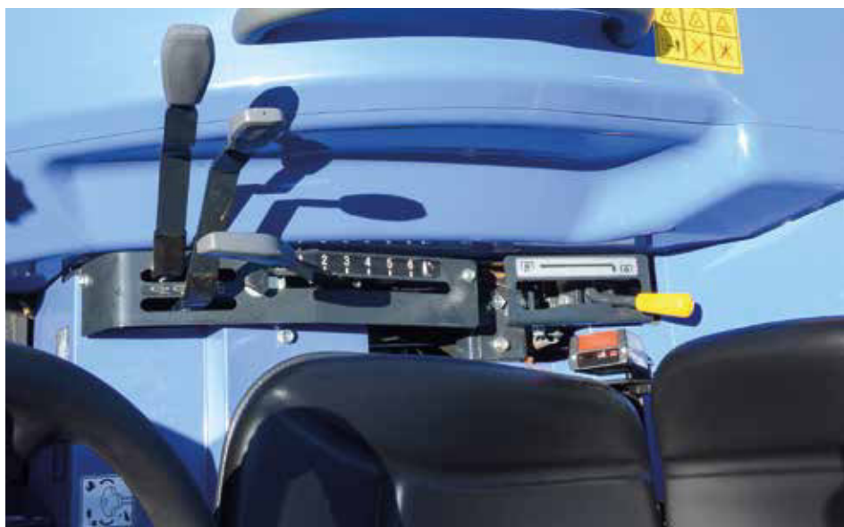
Isekis Farb-Code für die Bedienelemente: Rot steht für Fahrtrieb, Grau für die Hydraulik und Gelb steuert die Zapfwelle.
