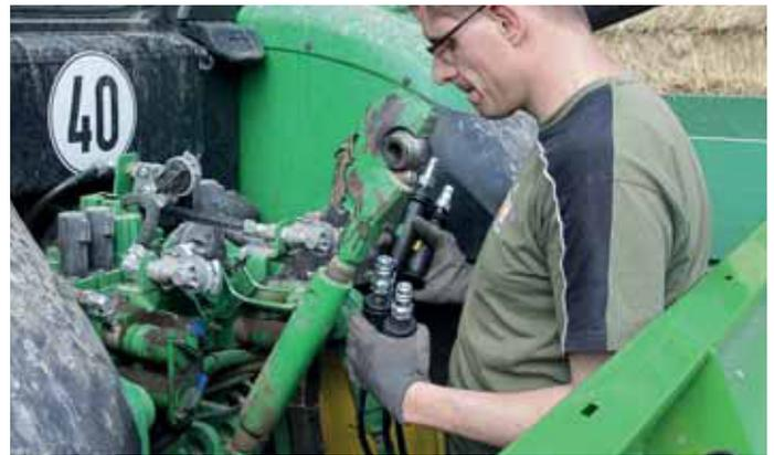
Neu bei Amazone: Griffe an den Hydraulikan schlüssen vereinfachen das An koppeln an den Traktor deutlich.
