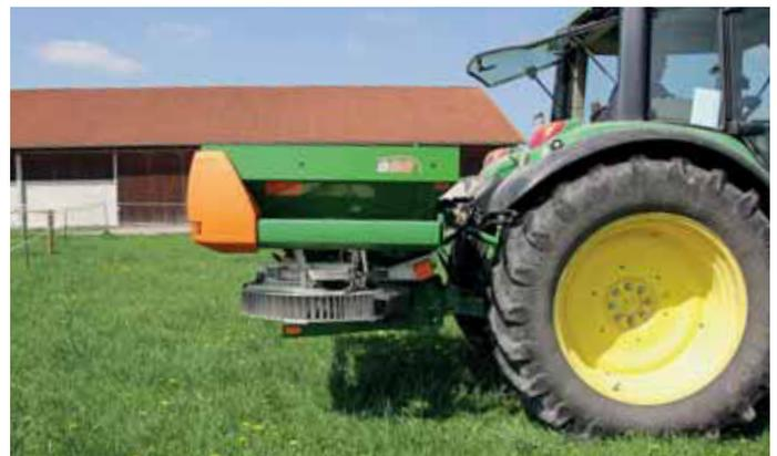
Der rippenförmige Limiter begrenzt bei Bedarf den seitlichen Auswurf.
