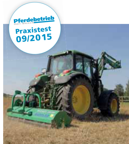
Der Mulch Mäxx BCH 220 von Bassler lässt sich dank Seitenverstellung um 40 cm verschieben.
